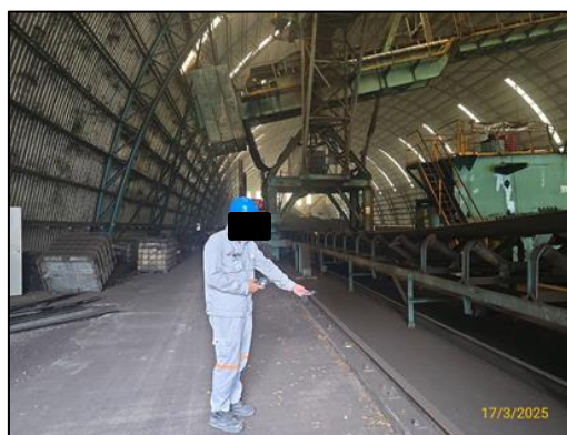
ภาพที่ 3.82 การตรวจวัดระดับความเข้มแสงในสถานที่ทำงาน จุดบริเวณทางเดินในโกดัง
